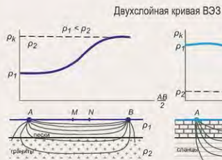
При малых разносах АВ \rho_1 \approx \rho_2 . С увеличением разносов ток будет все больше и больше проникать в слой 2 и \rho начнет уменьшаться пока не достигнет \rho_2 . Получаем 2-х слойную кривую с \rho_1 > \rho_2 .
