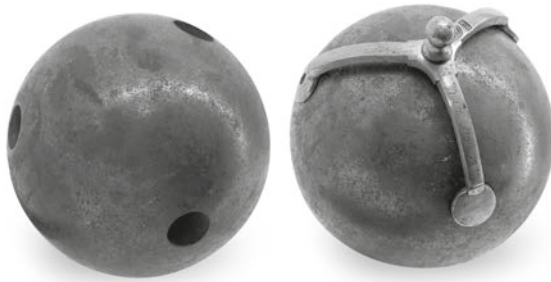
Рис. 9. Брандскугель Нижнеисетского завода и тот же брандскугель с инструментом Каменского завода для определения мест размещения пробок у брандскугелей 12-фунтового калибра. Из коллекции Горного музея
