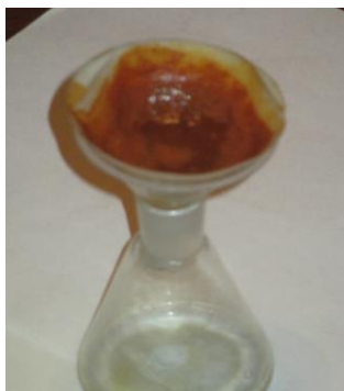
рис. 7. Определение «емкости» порошка яичной скорлупы
